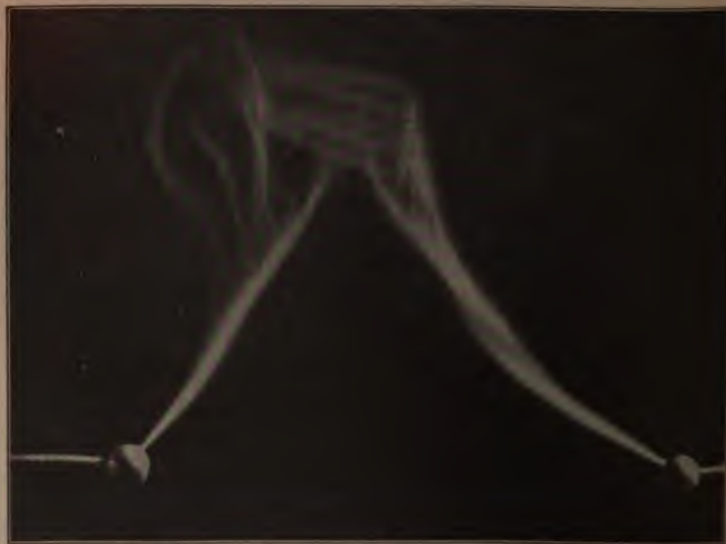
Abb. 278. Inaktive Entladung (Lichtbögen) eines Transformators.
